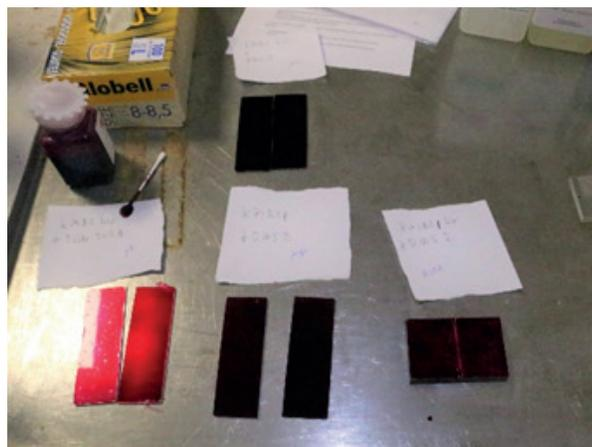
Figura 7 - Applicazione del liquido penetrante Elite K71B2P su diversi blocchi campione standardizzati.
