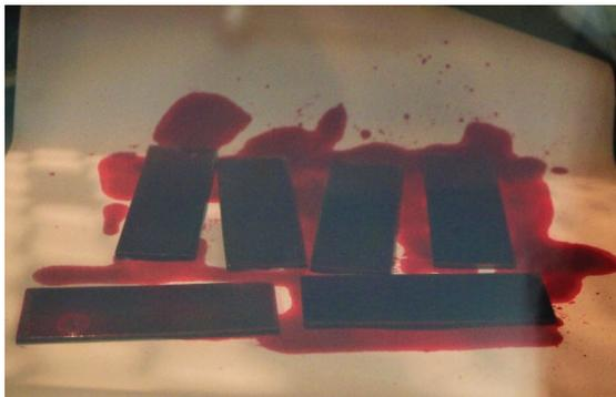
Figura 12 - Applicazione del liquido penetrante Elite K71B2P in cella climatica a -10 °C.
