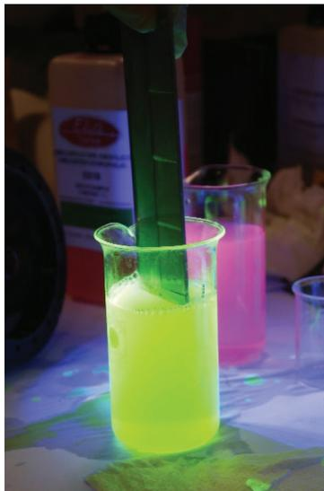
Figura 14 - Rimozione eccesso di penetrante Elite K81B in becher contenente solo 200 ml acqua.
