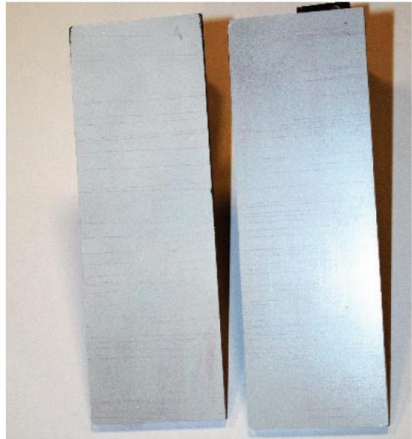
Figura 9 - Verifica della sensibilità eseguita con blocco Tipo 1 da 30  $\mu\text{m}$ , impiegando liquido penetrante Elite K71B2P ed Elite K71B2 bio con sviluppatore Elite D112A.
