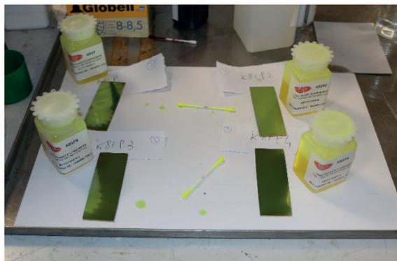
Figura 3 - Prove di sensibilità su prodotti della serie Elite K81P: applicazione del liquido penetrante.
