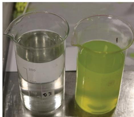
Figura 16 - Rimozione eccesso di penetrante Elite K81B in becher contenente acqua ed emulsificatore Elite E81B (immagine a sinistra e immagine centrale) e relativa comparazione tra i due becher contenenti le acque di lavaggio del metodo post-emulsionabile (becher a sinistra) e lavabile in acqua (becher a destra).
