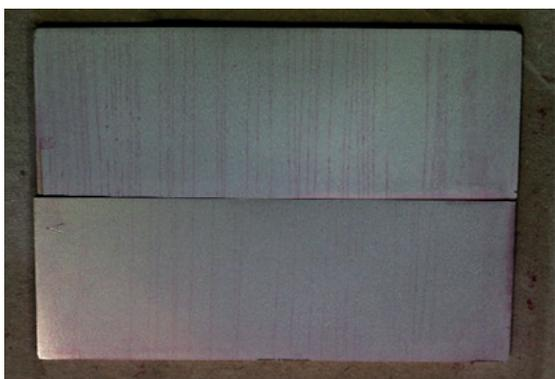
Figura 13 - Verifica della sensibilità eseguita con blocco Tipo 1 da 30 μm (in basso) e 50 μm (in alto), impiegando liquido penetrante Elite K71B2P e sviluppatore Elite D112A.
