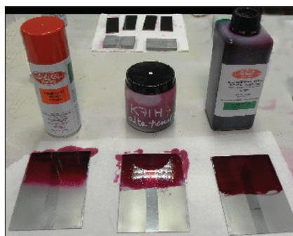
Figura 9 - Prova di lavabilità – applicazione del liquido penetrante su blocchi di lavabilità
