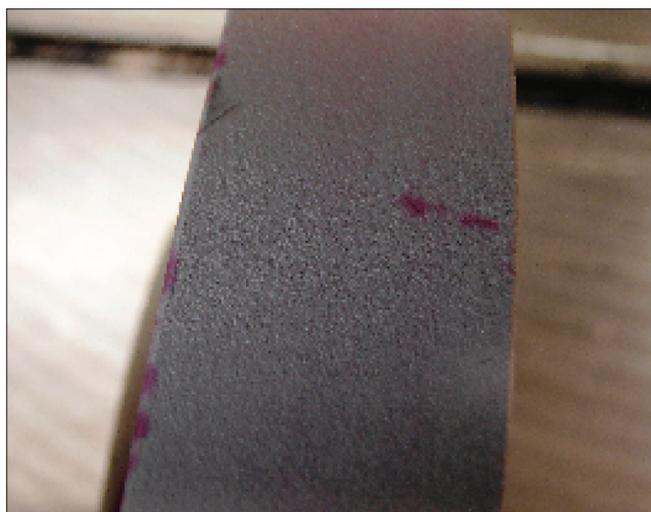
Figura 5 - Prova eseguita a 100 °C su flangia forgiata con Elite K71B2p e sviluppatore D112A
