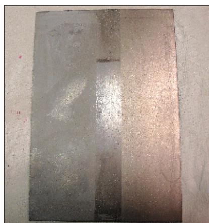
Figura 10 - Prova di lavabilità - Sviluppatore bianco D112A (a destra) a confronto con altro sviluppatore bianco (a sinistra) dopo il lavaggio
