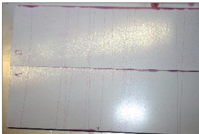
Figura 3 - Prova di sensibilità eseguita a 100 °C con Elite K71B2p su blocco di riferimento tipo 1 da 30 µm secondo ISO 3452-3
