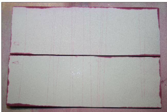
Figura 2 - Prova di sensibilità eseguita a 200 °C con Elite K71HT su blocco di riferimento tipo 1 da 30 µm secondo ISO 3452-3
