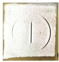
Fig.2: Polvere Magnetica Elite FW1 (duale) a confronto con il metodo tradizionale visibile particelle nere + lacca di fondo bianca
